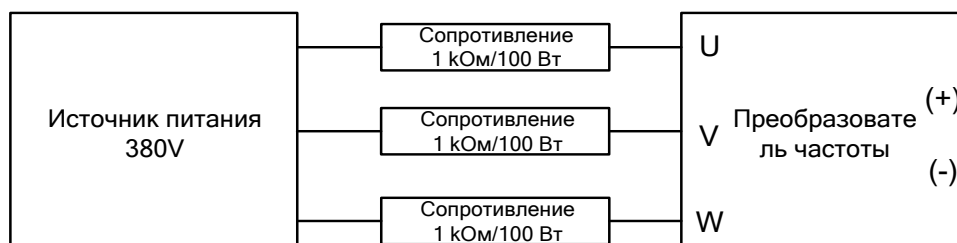
Рисунок 7-1 Пример схемы зарядки приводного устройства 380 В
